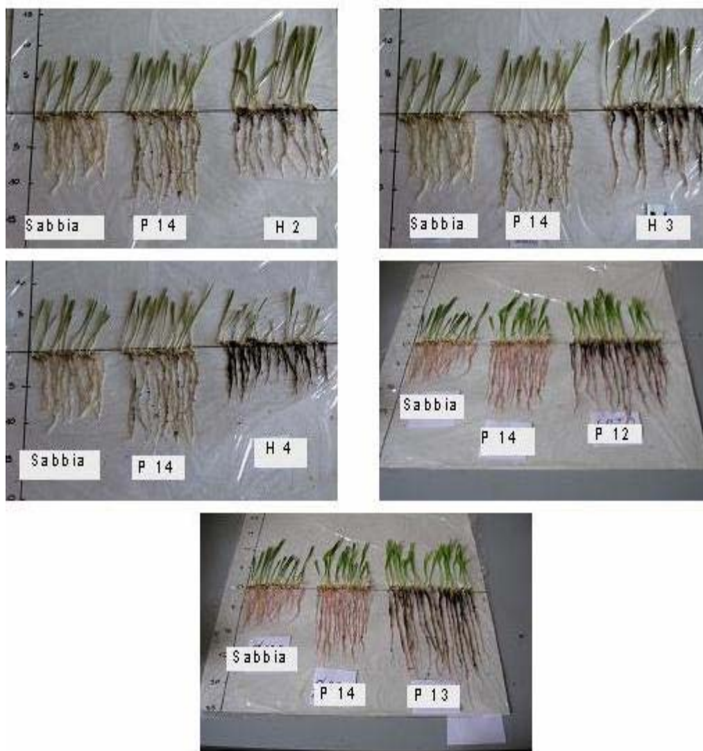
Figura 2. Alcuni esempi dei risultati del test ISO 11269-1 con Hordeum vulgare L. ottenuti sui substrati tal quali
