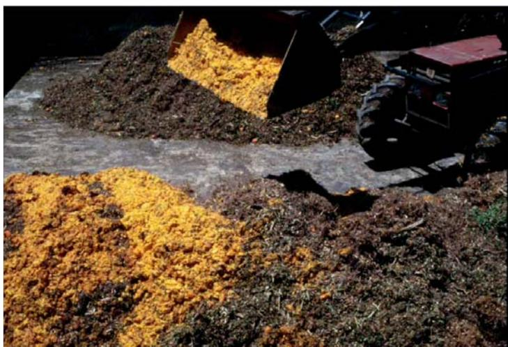
Figura 1. Miscelazione delle matrici, per l'allestimento dei cumuli
